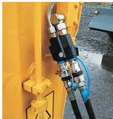
Connecteur hydraulique sur la pelle.
